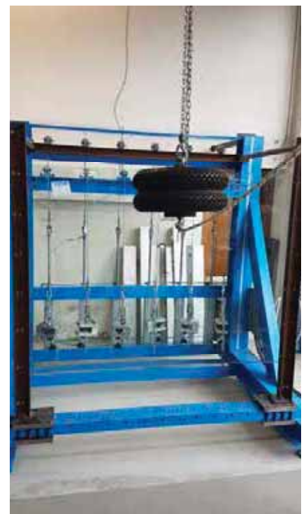
Testato con vite M8 testa cilindrica Tested with M8 cylindrical head screw Geprüft mit Zylinderkopfschraube M8
